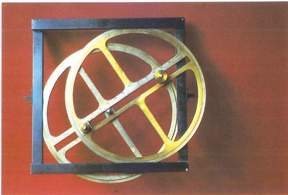
Ellissografo (o compasso ellittico): strumento in acciaio e ottone per il tracciamento di ellissi.
